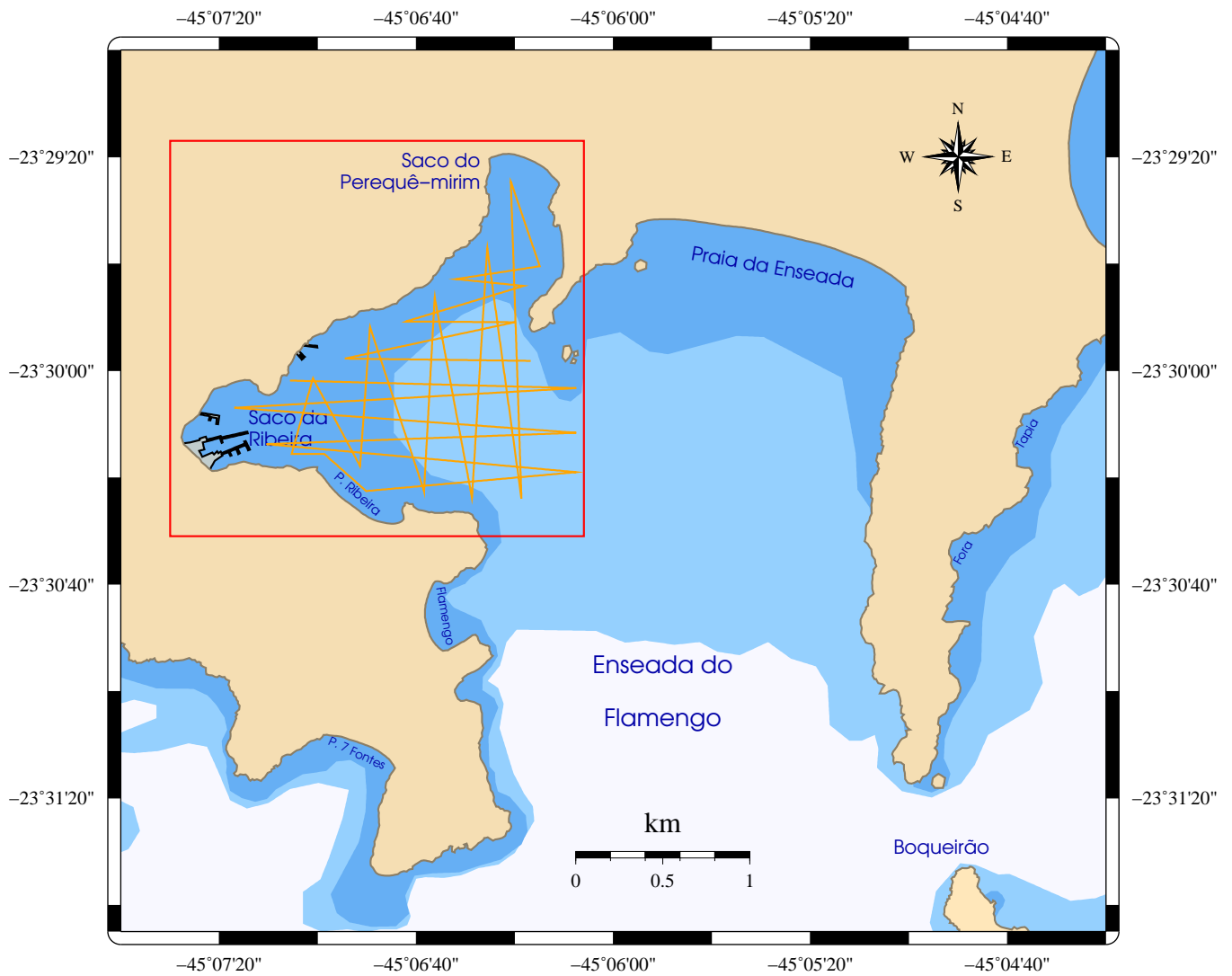
Figura 3.2: Mapa da enseada do Flamengo mostrando a trajetória que será percorrida no levantamento batimétrico. A latitude e longitude dos pontos que compõem esta trajetória encontram-se na Tabela 3.2. A área de abrangência do Atlas de Detalhe Operacional encontra-se demarcada em vermelho.
