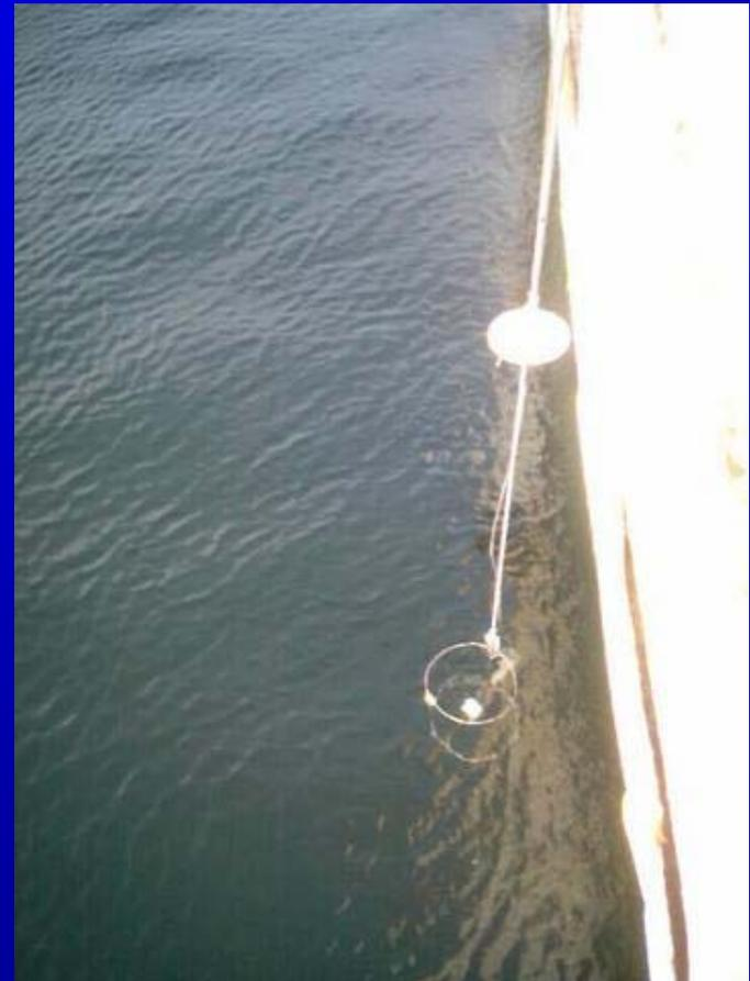
Secchi e sensor do radiômetro
