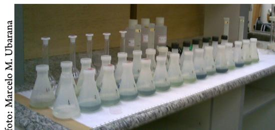
Figura 2.2: amostras para análise de silicato com coloração azulada após a adição dos reagentes.
